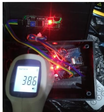
Gambar 14. Pengukuran Suhu IC Regulator Arduino Uno
