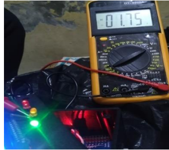
Gambar 13. Pengukuran Tegangan Pada LED
