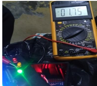
Gambar 13. Pengukuran Tegangan Pada LED
