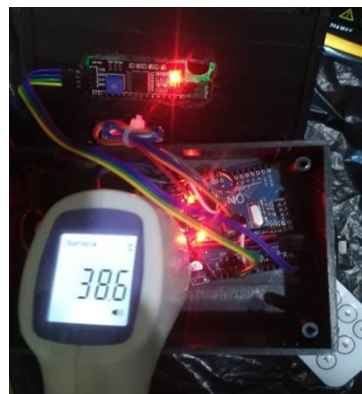
Gambar 14. Pengukuran Suhu IC Regulator Arduino Uno
