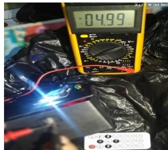
Gambar 11. Pengukuran Tegangan Sensor Inframerah
