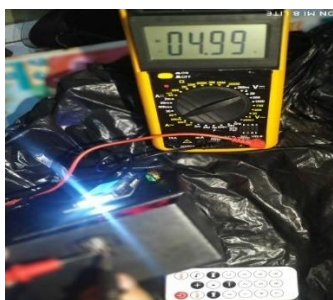
Gambar 11. Pengukuran Tegangan Sensor Inframerah
