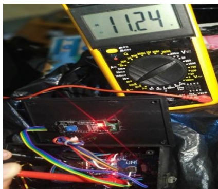
Gambar 10. Pengukuran Tegangan Mikrokontroler Arduino Uno
