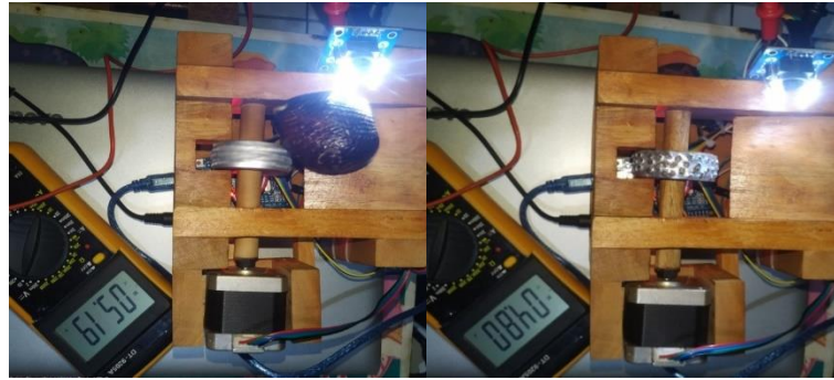
Gambar 13. Pengukuran Tegangan Sensor TCS3200 (Sumber: dokumen pribadi)
