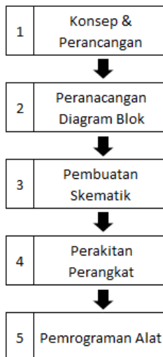
Gambar 1. Tahapan Perancangan dan Pembuatan Purwarupa Alat (Sumber: dokumen Pribadi)
