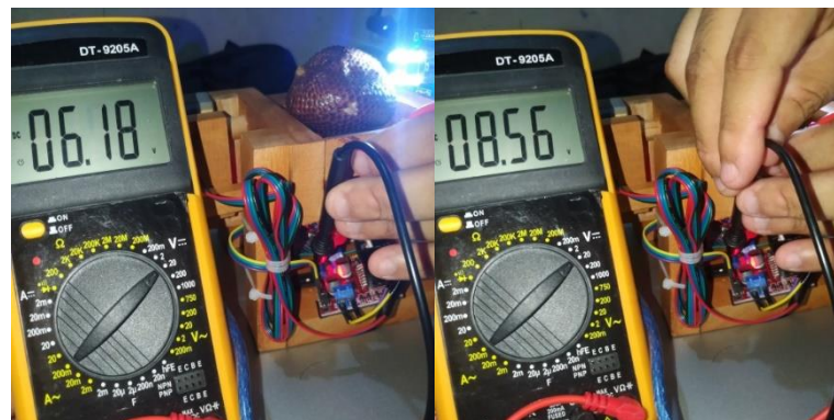
Gambar 14. Pengukuran Tegangan Stepper Bipolar (Sumber: dokumen pribadi)
