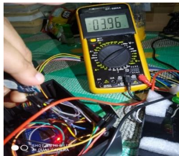
Gambar 12. Pengukuran Tegangan Komponen Buzzer (Sumber : dokumen pribadi)
