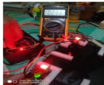
Gambar 13. Pengukuran Tegangan pada LED (Sumber : dokumen pribadi)
