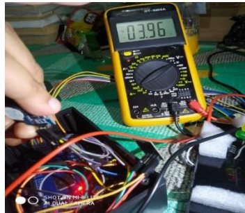
Gambar 12. Pengukuran Tegangan Komponen Buzzer (Sumber : dokumen pribadi)
