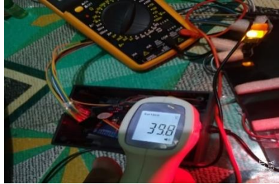
Gambar 14. Pengukuran Suhu Pada IC Regulator Aduino (Sumber : dokumen pribadi)
