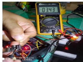
Gambar 11. Pengukuran Tegangan ESP8266 (Sumber : dokumen pribadi)
