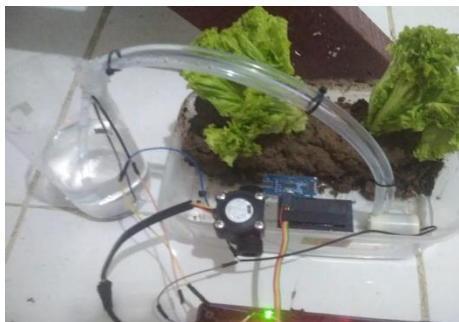
Gambar 16. Proses Pengendalian Air Parit Dalam Kondisi Kurang Air
