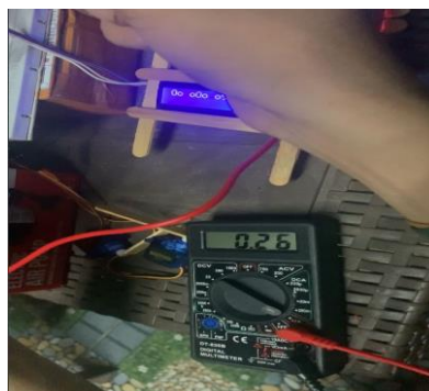
Gambar 8. Pengukuran Arus pada Alat
