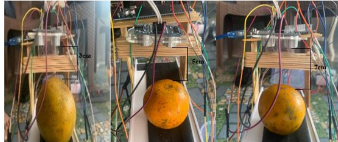
Gambar 9. Pengujian Jarak Permukaan Jeruk
