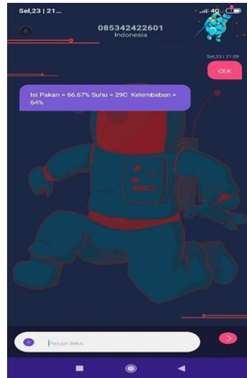
Gambar 14. Hasil Uji Monitor Modul GSM SIM800L
