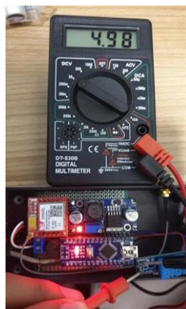
Gambar 11. Pengukuran Tegangan Sensor Kelembaban dan Suhu DHT11
