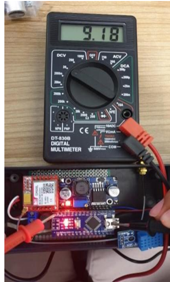
Gambar 6. Pengukuran Tegangan Arduino Nano
