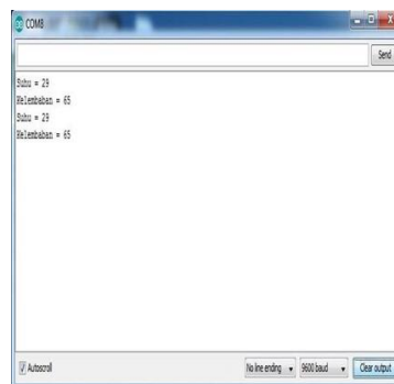
Gambar 13. Hasil Pembacaan Sensor Kelambaban dan Suhu DHT11
