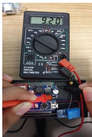
Gambar 9. Pengukuran Tegangan Modul DC to DC
