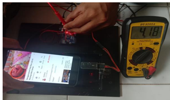
Gambar 9. Pengukuran Tegangan Sensor Suara Mendeteksi Suara
