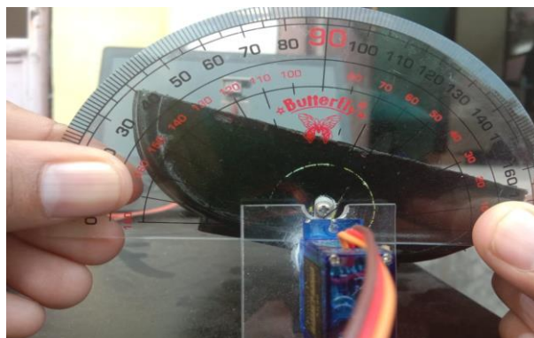
Gambar 15. Motor Servo Dalam Keadaan Posisi 85 Derajat
