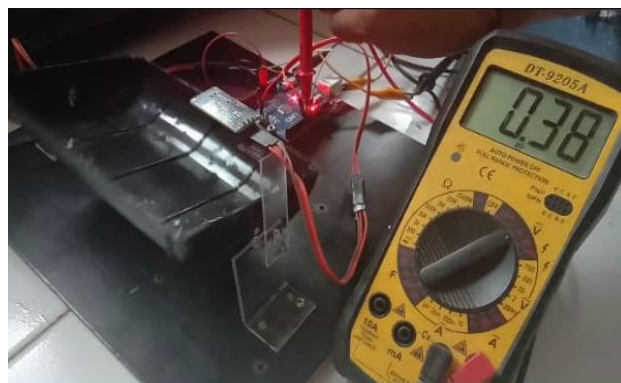
Gambar 14. Hasil Pengukuran Tegangan Motor Servo Posisi Sudut 125 Derajat
