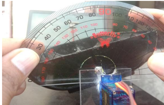
Gambar 13. Motor Servo Dalam Keadaan Posisi 125 Derajat Ke kiri
