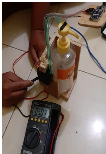
Gambar 8. Pengujian dan Pengukuran Tegangan Servo Pada Kondisi Low (Tidak Bergerak)
